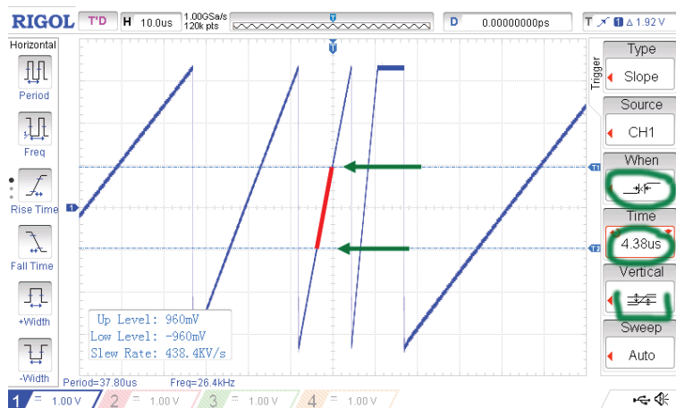
Rysunek 6. Wyzwalanie nachyleniem zbocza
