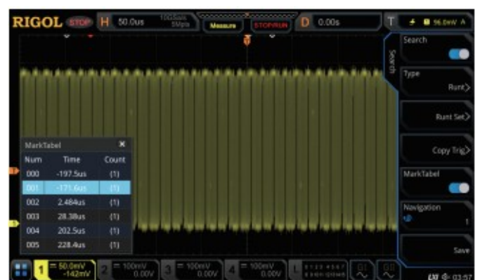
Funkcja wyszukiwania i nawigacji pozwala szybko wyszukiwać sygnały z zakłóceniami i dokładnie je lokalizować.
