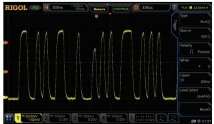
Wyzwalanie wysokością impulsu Runt pomaga wychwytywać w ciągu impulsów przebiegu impulsy o zaniżonej amplitudzie.
