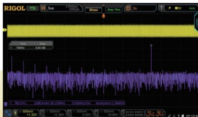
Wykorzystując sondę bliskich pól EM, użytkownik może łatwo obserwować piki widma w dziedzinie częstotliwości przy zbliżeniu sondy do punktu obwodu, w którym emitowane są zakłócenia.
