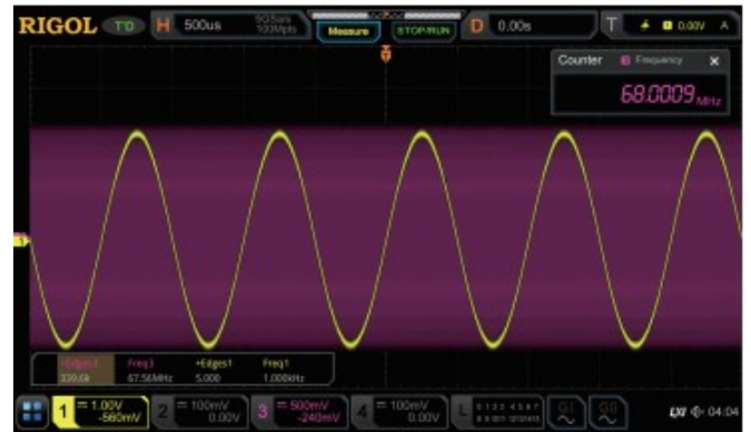
Obserwacja i dokładne pomiary dwóch sygnałów z dużą dewiacją częstotliwości. Pomiar sprzętowy całej pojemności pamięci akwizycji umożliwia dokładne pomiary wartości częstotliwości przebiegów z 339 600 zboczami narastającymi.
