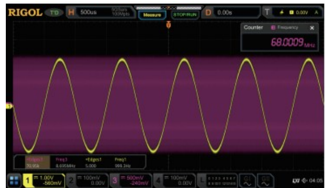
Zwykły 1 Mpkt. pomiar programowy nie pozwala na dokładne pomiary wartości częstotliwości sygnałów wysokoczęstotliwościowych.
