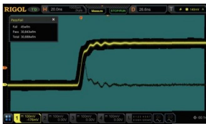
Funkcja testu Dobry/Zły umożliwia wykonanie szybkiej statystyki prawdopodobieństwa pojawienia się odchyłek sygnału od wartości wzorcowej.
